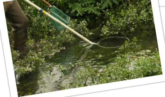
▲ L'anode (cercle métallique) génère un courant électrique lorsqu'elle est plongée dans l'eau, ce qui attire le poisson vers elle
